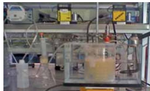
Figura 1. Reactor para reproducir bacterias productoras de PHA (izquierda); reactor para cultivar el biopolímero usando control de procesos (derecha).
